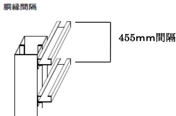
図 10 鉄骨造のラスシート下地
