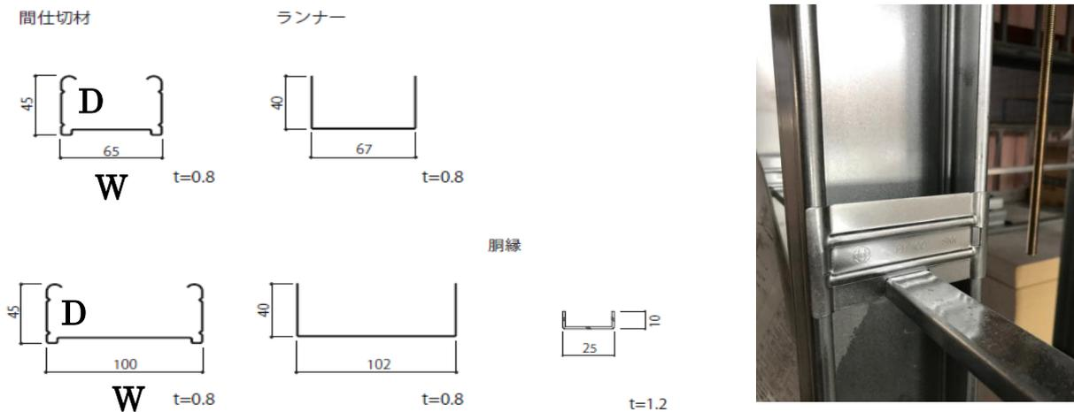
図 4 建築用構成下地材の形状例
