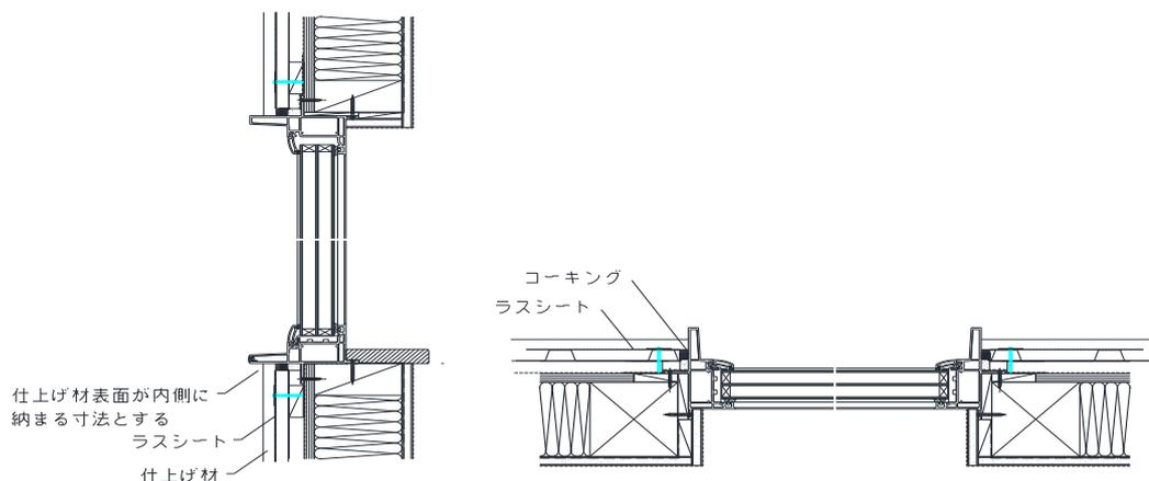
図 20 外付け窓の開口部の納まり
