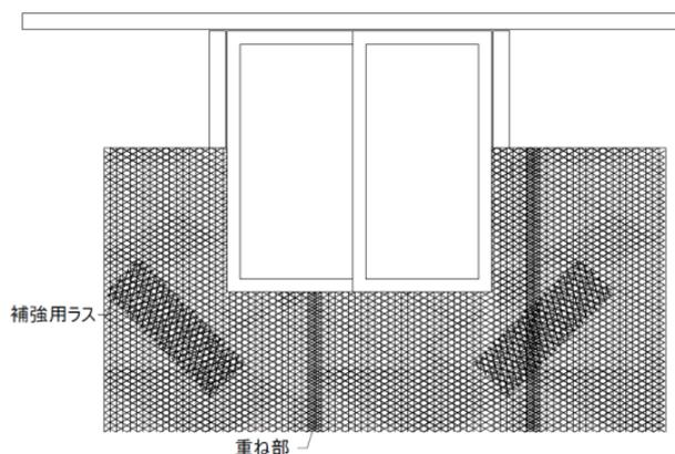
図 21 開口部廻りの補強例
