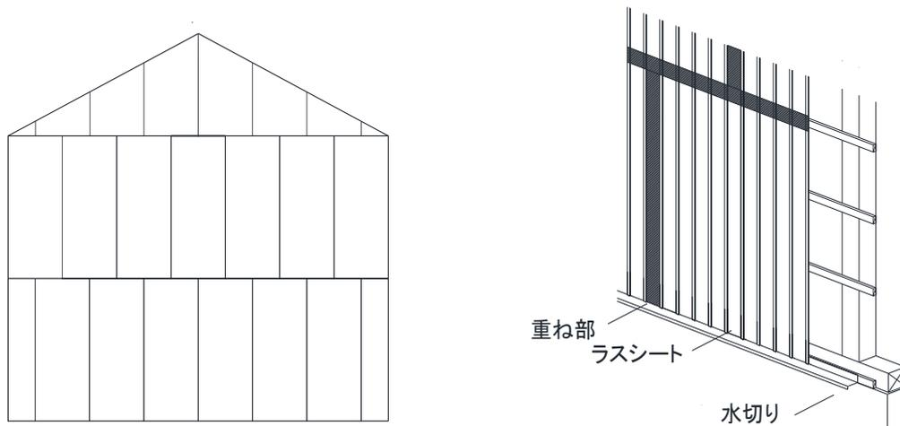
図 12 ラスシートの割り付けの例
