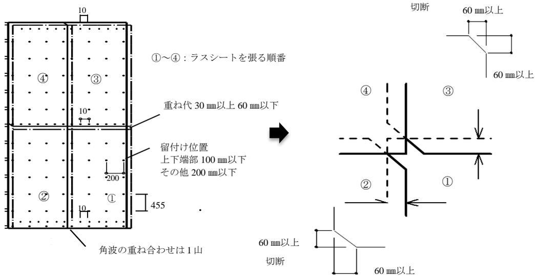
図 17 ラスシートの重ね加工と納まり例
