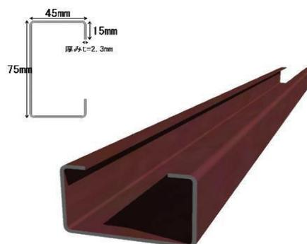
図 3 リップ溝形鋼の形状例
